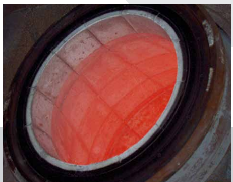
1 2 \ Precast shapes lining Revestimiento en piezas
