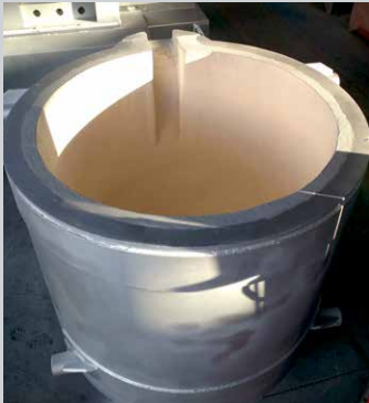
\ Ladle lining Revestimiento de cuchara
