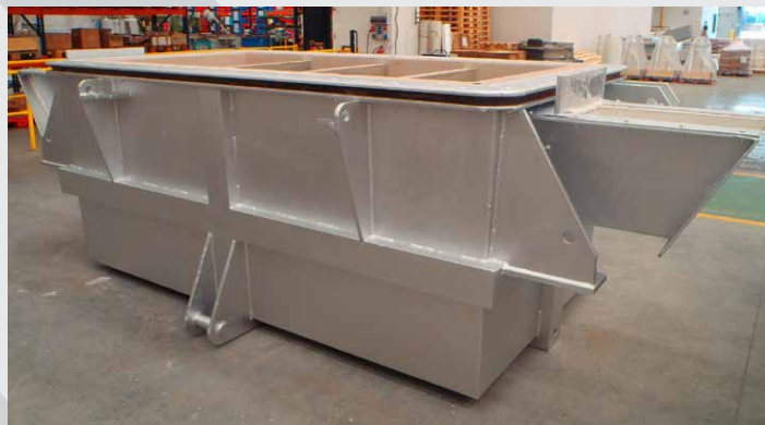
Desgasing vent \ Caja desgasificado
