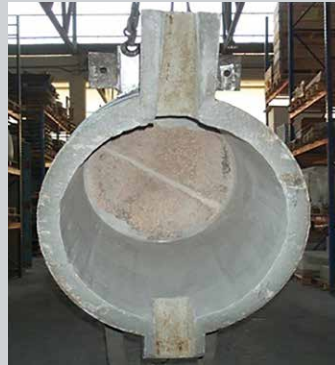
\ lining with precast shapes & castables Revestimiento con pieza prefabricada y hormigones
