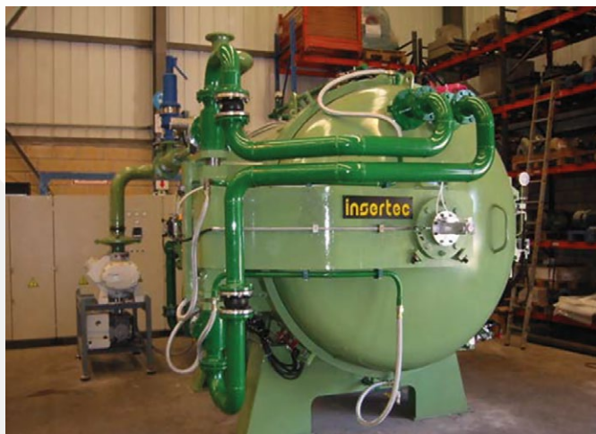
\ Horno de vacío para temple en nitrógeno hasta 10 bar.
