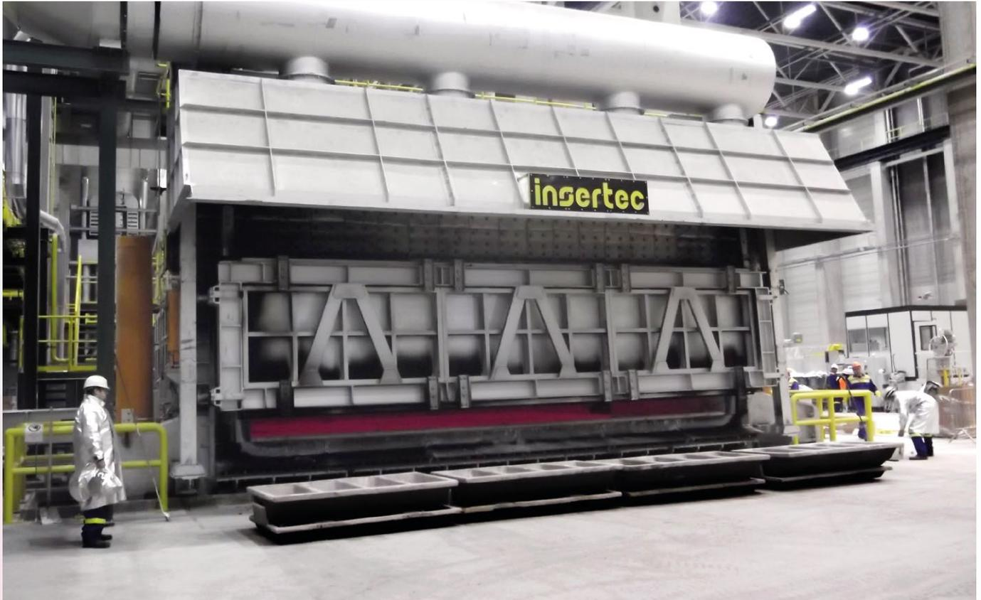
Horno Reverbero basculante FRLB, para fusión y mantenimiento de aluminio, con capacidades desde 15 a 150 Ton.
