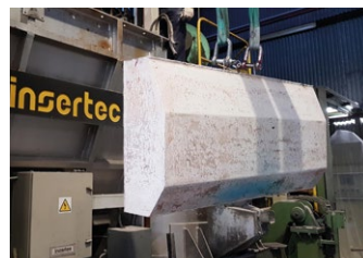
\ Revestimiento en pieza prefabricada
