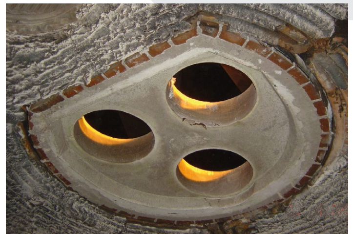
\ Precast Shape Delta Delta en Pieza prefabricada
