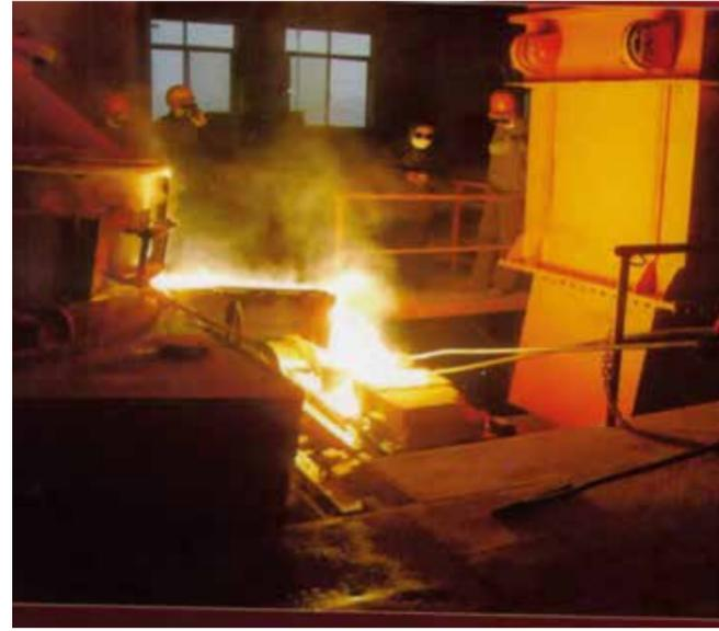
Recientemente Insertec ha incorporado a su amplia gama de piezas conformadas piezas especiales de electrofundido AZS.
