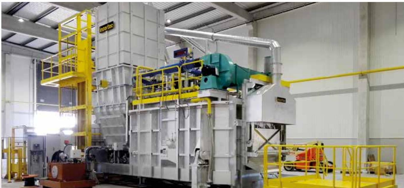
Horno Central de fusión rápida, MELTOWER®, para la refusión de retornos y lingotes de aluminio en Plantas que demandan una producción regular de aluminio líquido.
