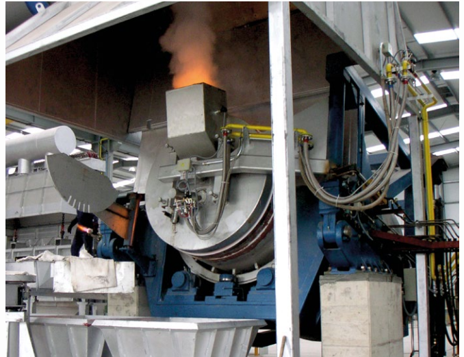
\ Instalación completa Rotativo FARB-12, con puerta, retenedor, reguera móvil y carro recogida escorias
